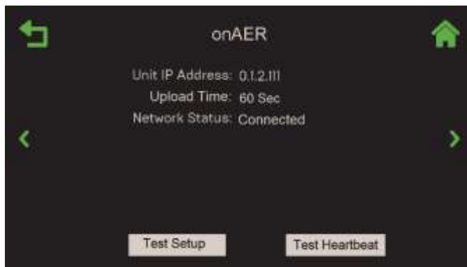
Figure 4-23 : Écran Communication & Failsafe : onAer
