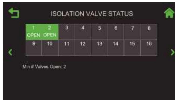
Figure 7-12 : Écran Isolation Valve Status
