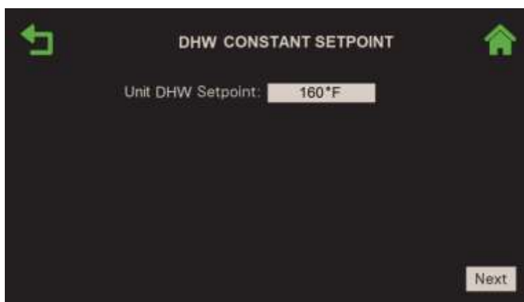
Figure 2-18 : Écran Standalone – DHW : DHW Constant Setpoint
