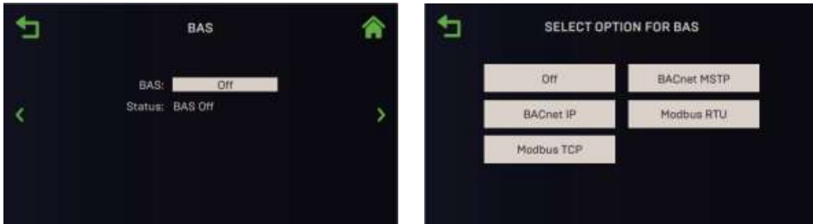
Figure 6-56 : Écran Communication & Failsafe : BAS
