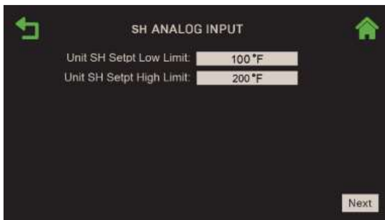
Figure 2-11 : Écran Standalone – Space Heating : SH Analog Input
