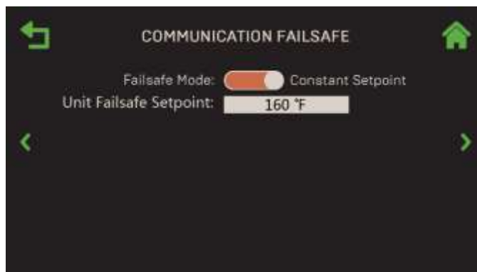
Figure 6-64 : Écran Communication & Failsafe : Communication Failsafe
